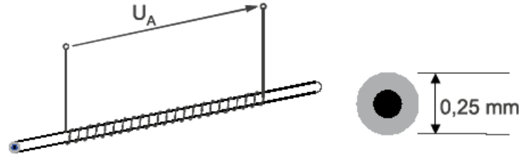
Fil Wiegand entouré du bobinage de détection.
